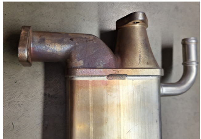
Blasen- und Rissbildung (links) und deutliche Verfärbungen (rechts) – typische Schadensbilder bei thermischer Überlastung
